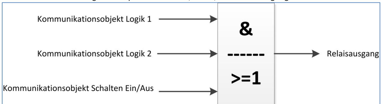
Abbildung 15: Logikfunktionen - Prinzip Skizze
